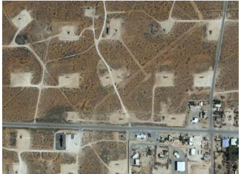
Abbildung 3: Luftaufnahme eines erschlossenen Schiefergasfeldes in New Mexico (USA) mit mehreren verlassenen Bohrfeldern. Unten rechts sind parkierte Lastwagen und Gebäude der fördernden Unternehmen zu sehen. Quelle: https://maps.google.de/?ie=UTF8&ll=32.830847,-104.011002&spn=0.155493,0.308647&t=k&z=12
