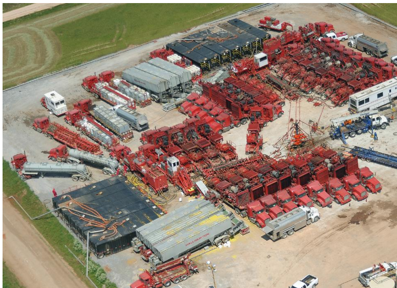
Abbildung 2: Diese Luftaufnahme einer Bohrstelle zeigt die mobile Infrastruktur, die für die Gewinnung des Schiefergases notwendig ist. Quelle: S. Bukhold
